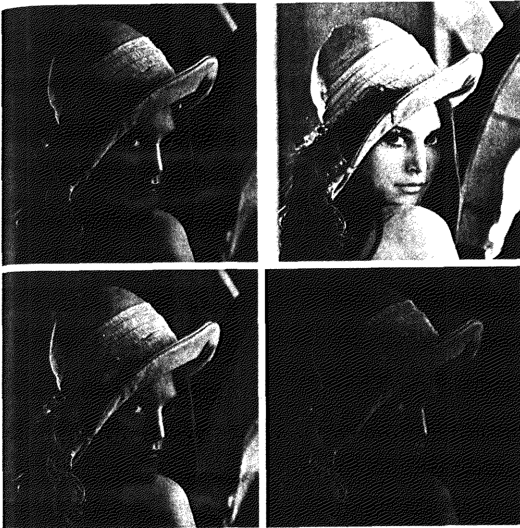
a b c d FIGURE 6.38 (a) RGB image. (b) Red component image. (c) Green component. (d) Blue component.
